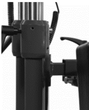
Figuur 3: Klemschakelaar voor hoogteverstelling van de tafel
